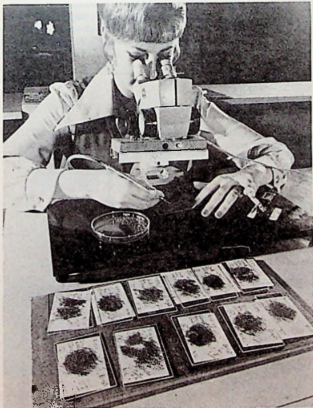
De fabricage van RCA-halfgeleider-componenten voor de Europese markt zal binnenkort in België te Luik plaatsvinden. De foto illustreert op welke wijze voor de vermogens transistoren de pellets, ter grootte van een speldeknoopje, m.b.v. een sterke microscoop worden geïnspecteerd en geselecteerd. Sch.
